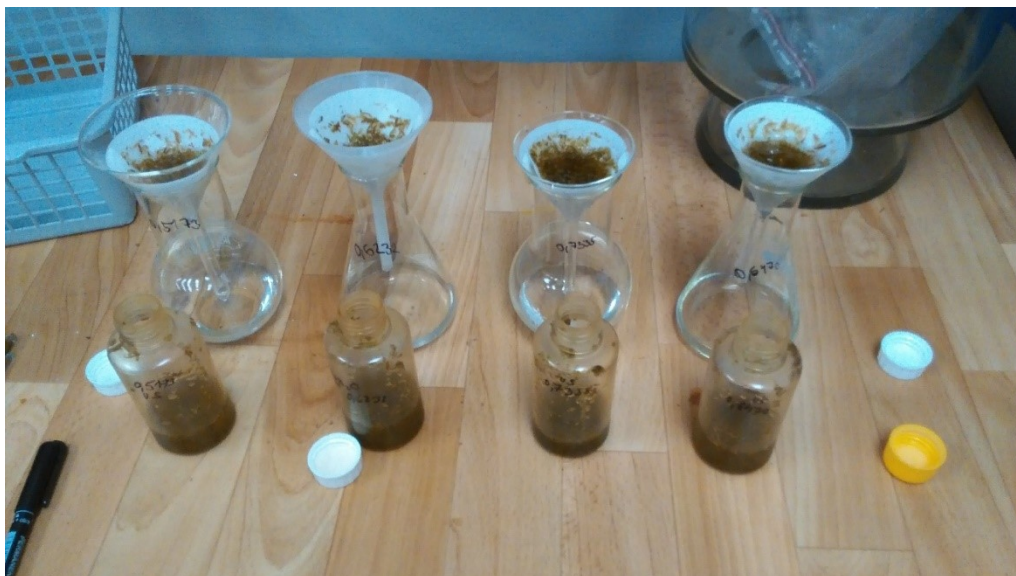
Obrázek č. 7.: Filtrace vzorků
