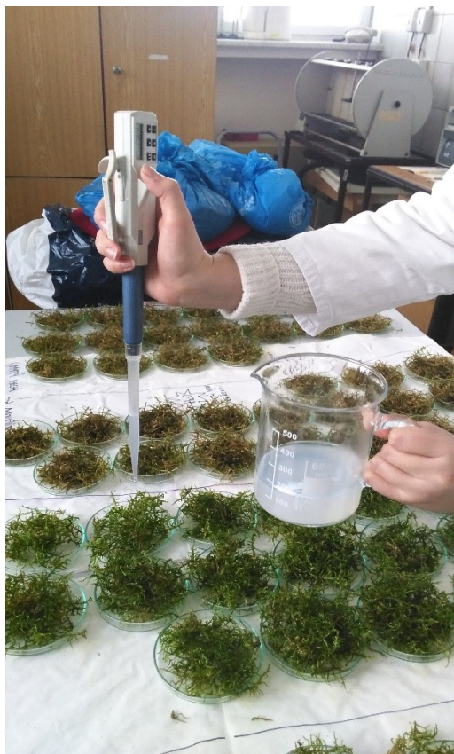
Obrázek č. 6.: Aplikace suspenze ZnO
