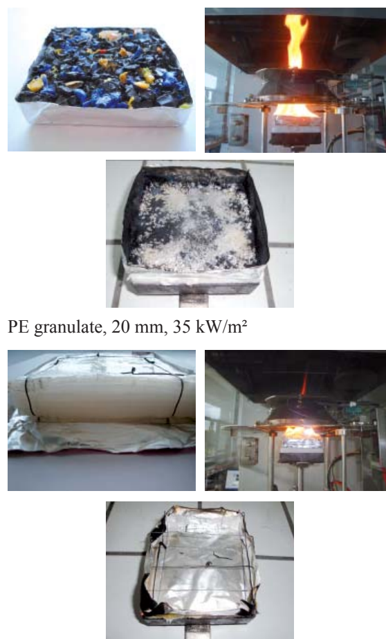
PE foil, 21 mm, 35 kW/m 2
