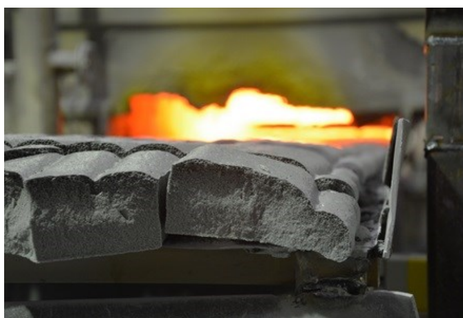
Obr. 13: Pěnové sklo při opouštění vysokoteplotní pece [9]
