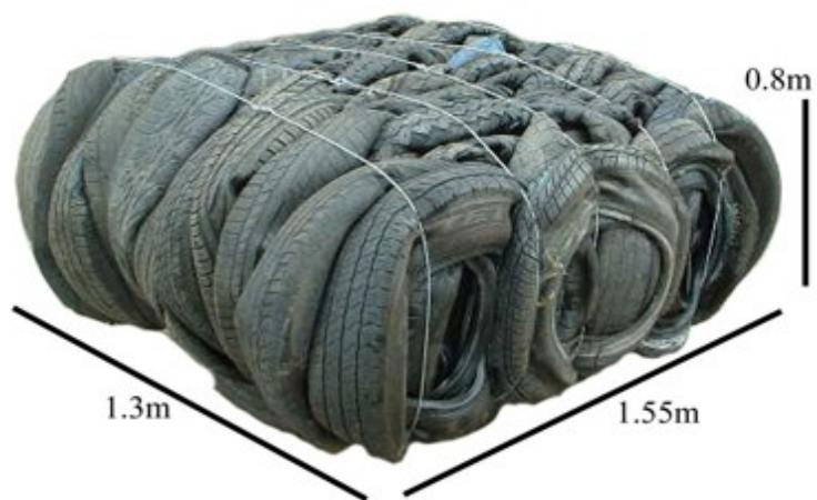
Obr. 3: Balík ze slisovaných pneumatik [4]
