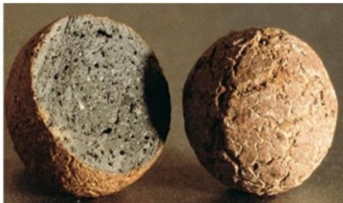
Obr. 1: Keramické kamenivo, velikost: 0 – 16 mm [2]
