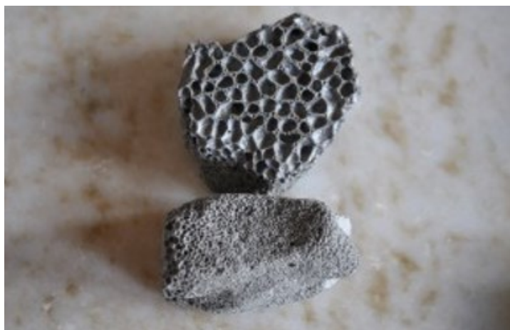
Obr. 12: Pěnové sklo, velikost: 10 – 60 mm [3]
