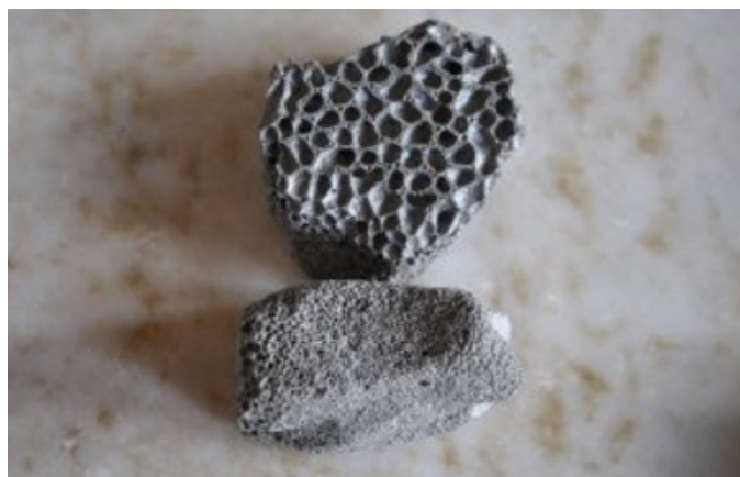
Obr. 2: Pěnové sklo, velikost: 10 – 60 mm [3]
