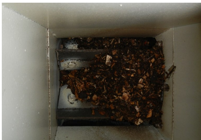
Obr. 5 - Vnitřní pohled na turniket paliva.
