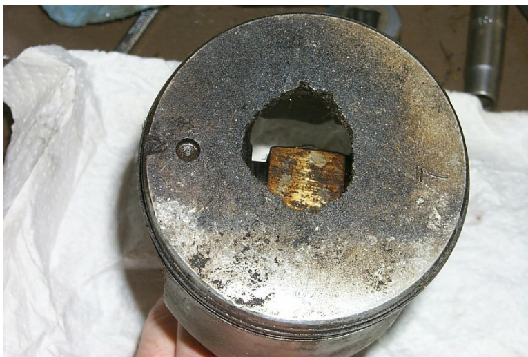
Obr. 1 - Příklad poškodenia piestu detonačným spaľovaním
