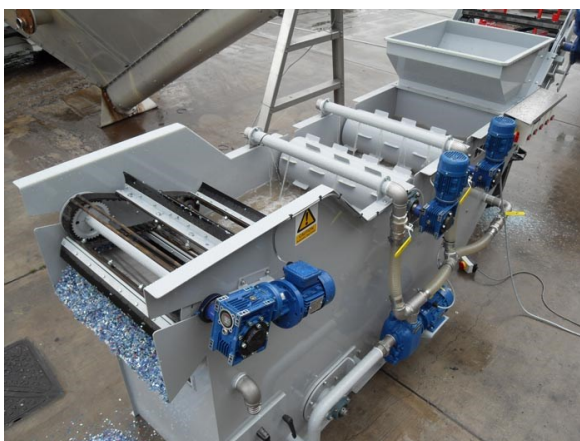
Obr.č. 3.5. Sink-Float separátor [11]
