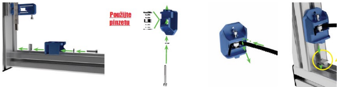
Obr. 4.9 Umístění dílu pro vedení řemene [14]
