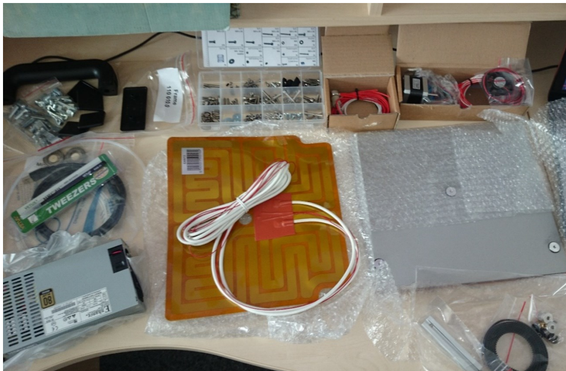
Obr. 4.1 Obsah balení: vyhřívaná deska, šrouby, motory
