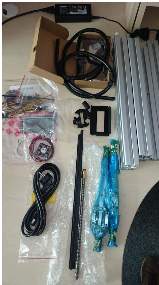
Obr. 4.3 Pojezdy, pohybový šroub, větrák, motorky, hliníkové rámy
