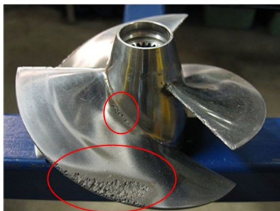
Obr. 2.1 Poškození lodního šroubu vlivem kavitační eroze [20]
