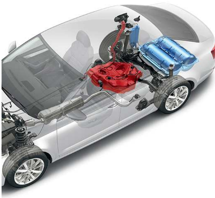
Obr. č.2.7 způsob umístění palivových nádrží u automobilu ŠKODA Octavia G-TEC [1]
