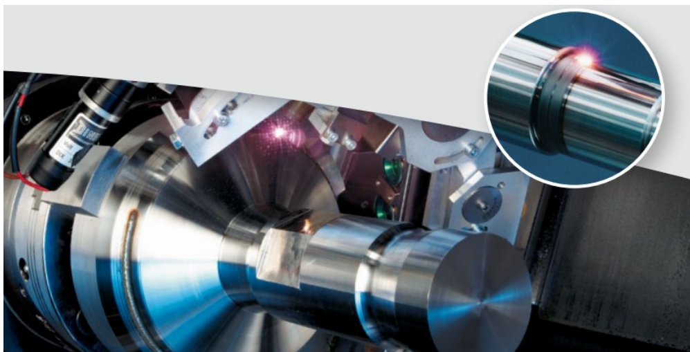
Obr. 25 Navařování za pomoci laseru [18]
