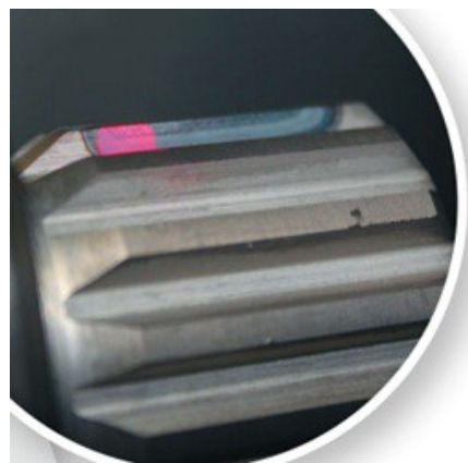
Obr. 24 Laserové kalení boku zubu [18]
