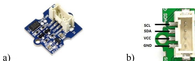
Obr. 2.11 - Grove - 3-Axis Digital Accelerometer: a) náhled [8] , b) Schéma I/O
