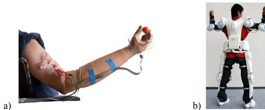
Obr. 2.9 – Využití technologií elektromyografie: a) invazivní – protéza lidské ruky [5] , b) povrchová – exoskeleton HAL [6]
