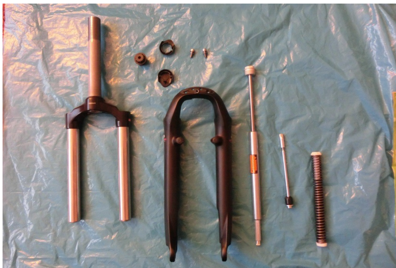
Obrázek 11.3- rozmontovaná poškozená vidlice
