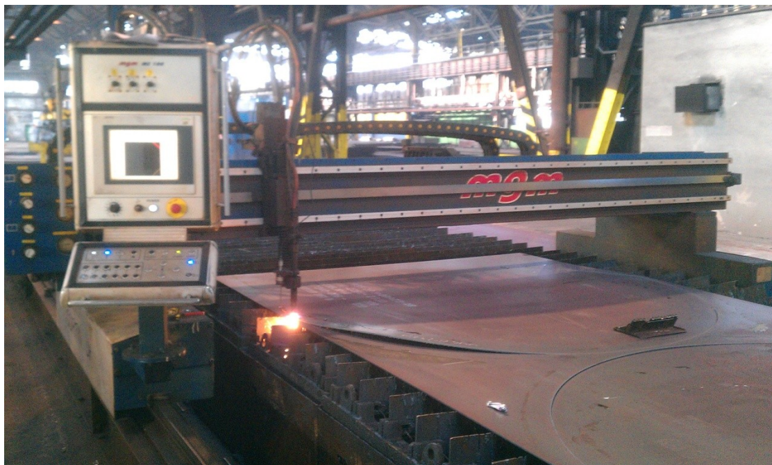
Obr. 14 Plamenový řezací stroj CORTINA DP 4000 [9]
