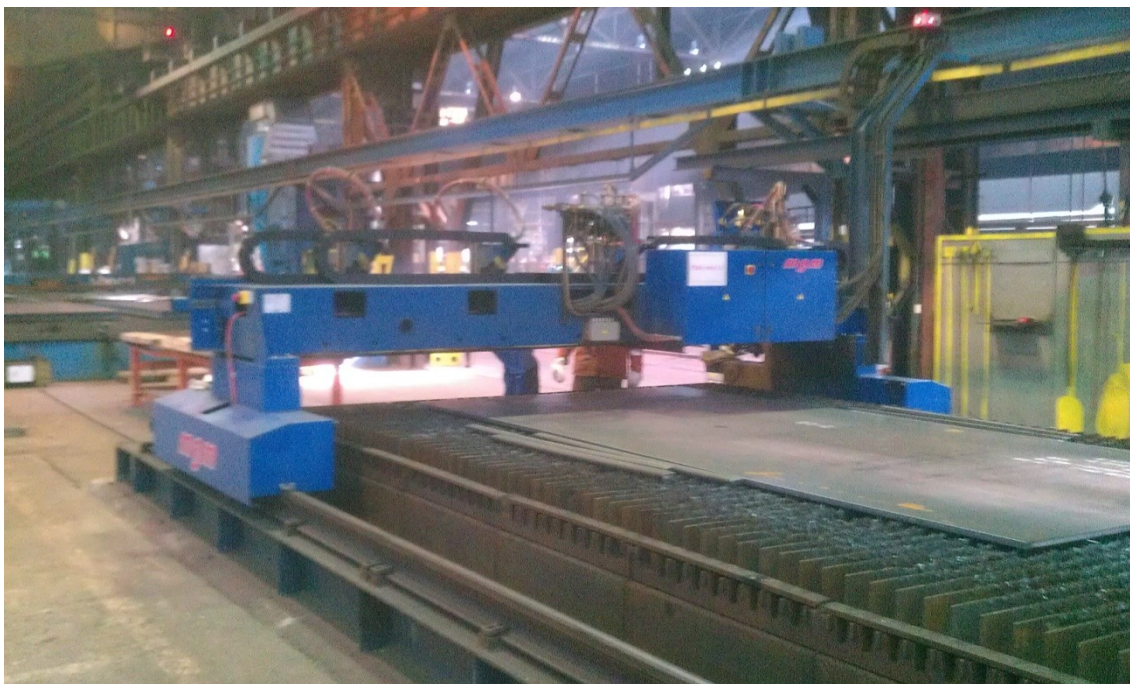
Obr. 15 Plamenový řezací stroj OMNIMAT L 4600 [9]
