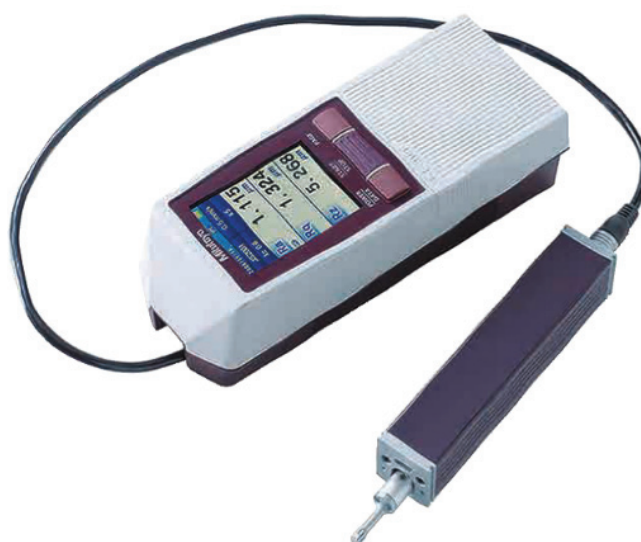
Obr. 2.4 – Měřicí přístroj SurfTest SJ-210 pro měření drsnosti povrchu [7]
