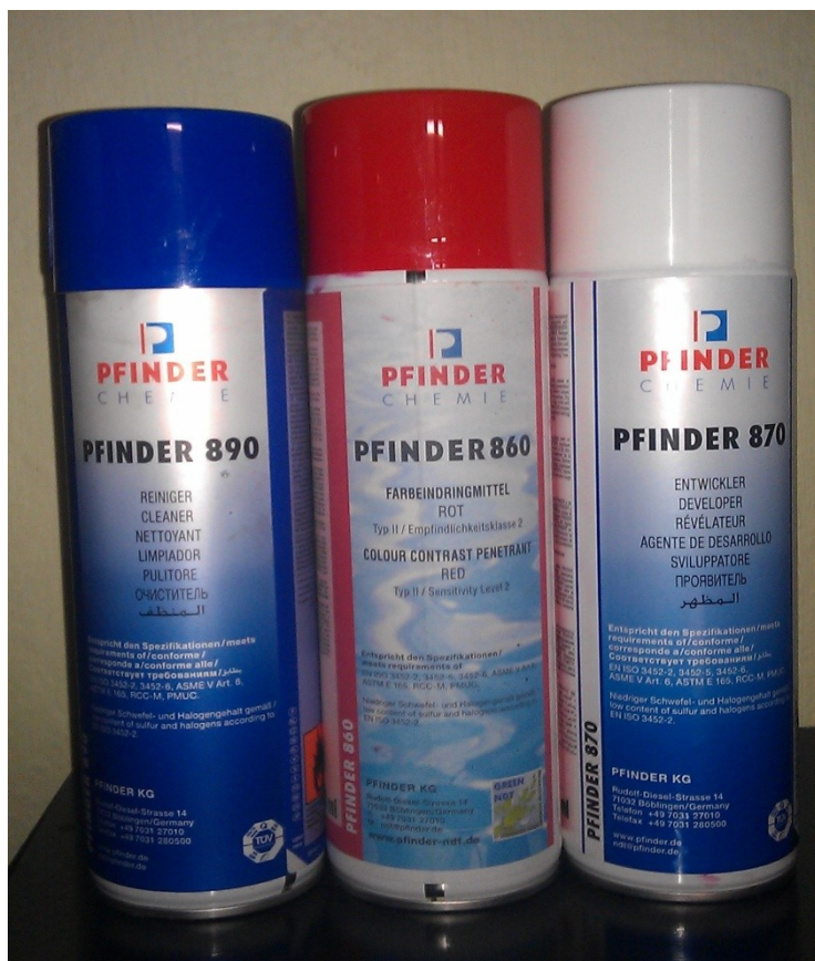
Obrázek 4.20. Spreje na kapilární testování defektů svarů [autor]
