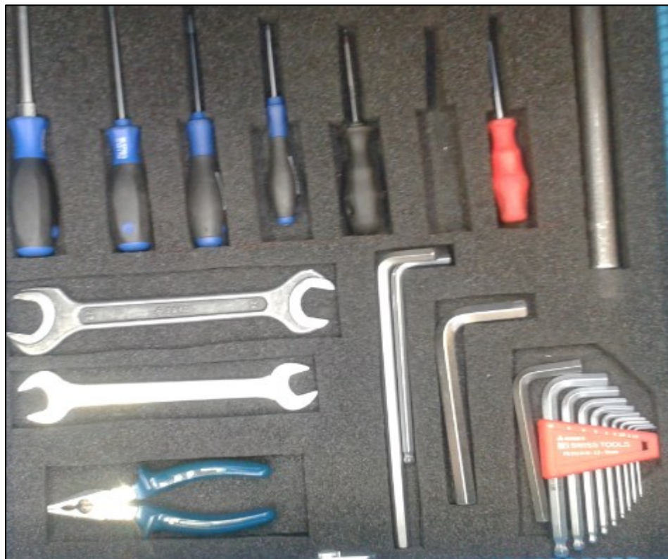
Obr. č. 56 Systematizace náradí pomocí tvrzené pěny
