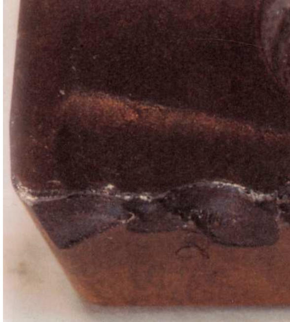
Obr. 2.12 Lom břítu nástroje [20]
