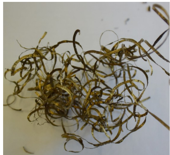
Obr. 7.5 Vzniklá tříška za řezných podmínek:
