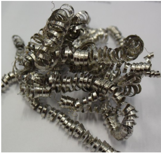
Obr. 7.10 Vzniklá tříška dle řezných podmínek:
