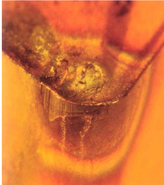
Obr. 2.5 Opotřebení ve tvaru žlábků
