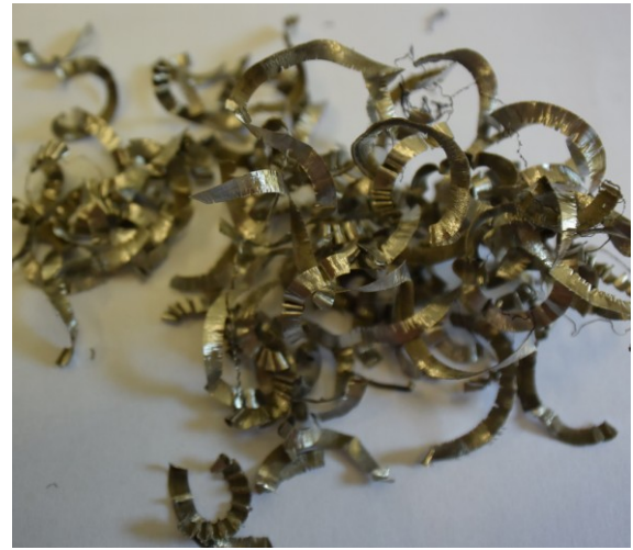
Obr. 7.11 Vzniklá tříška dle řezných podmínek:
