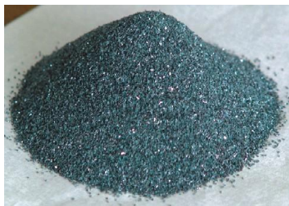
Obr. 1.15 Karbid křemíku C48 černý[6]
