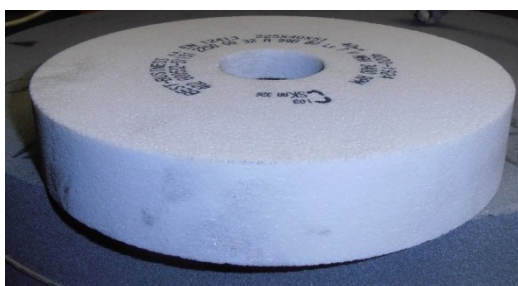
Obr. 4.1 Kotouč z umělého bílého korundu A 99B
