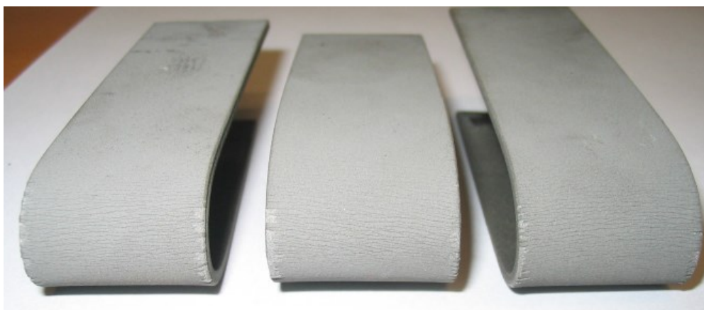
Obr. č. 35 – Výsledek zkoušky ohybem prášku WC-Co-Cr 86-10-4
