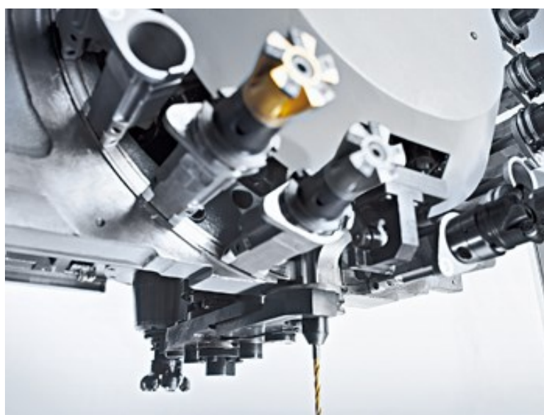
obr. 9 AVN s dvouramenným výměníkem a sklopnými lůžky DMG Mori [9]
