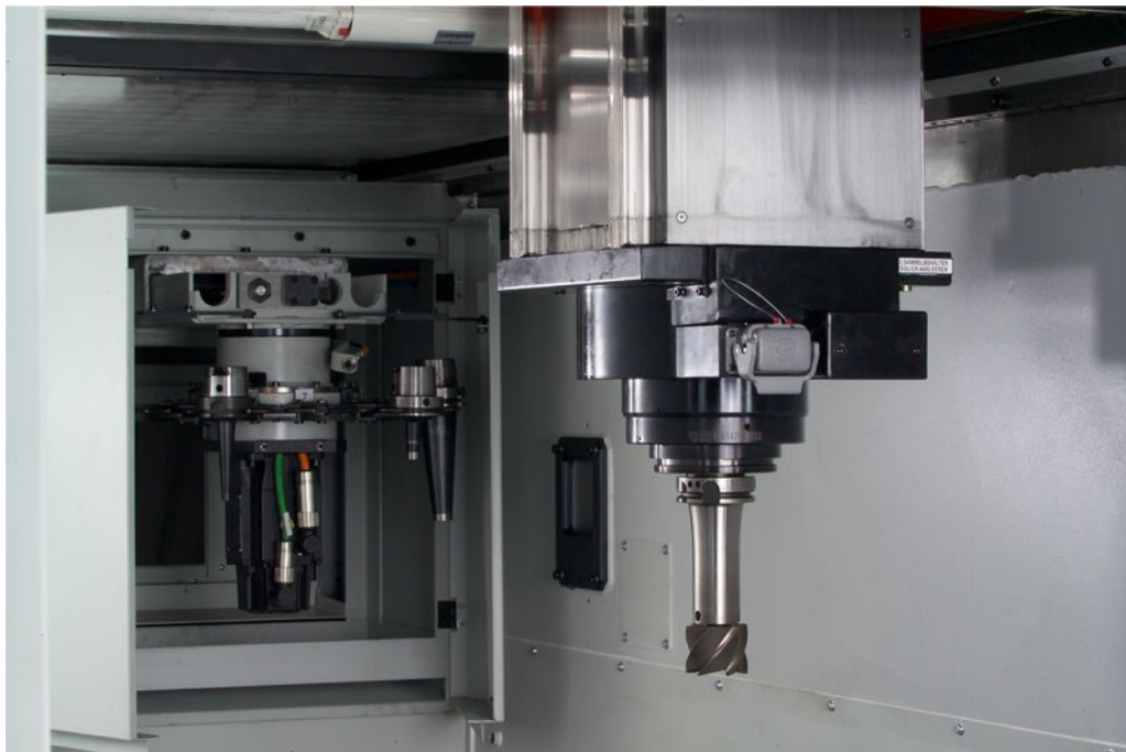
obr. 7 Kotoučový zásobník nástrojů Trimill a.s. [10]
