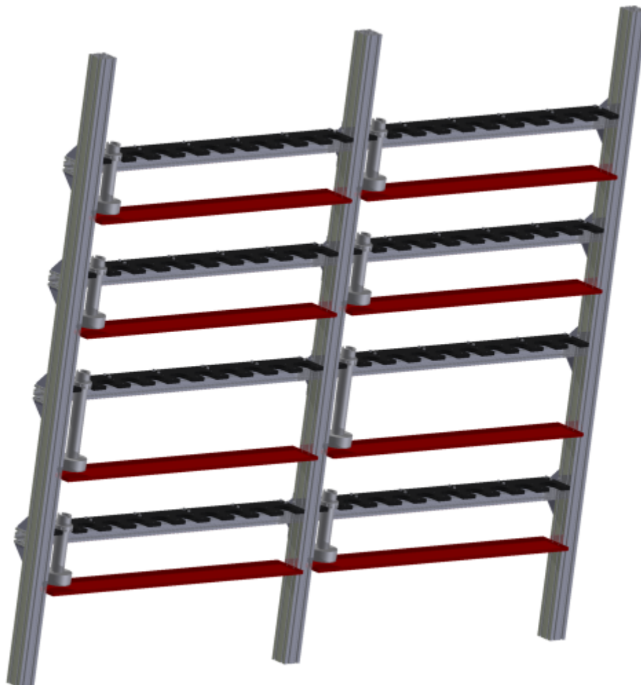
obr. 26 Konstrukce zásobníku - celek
