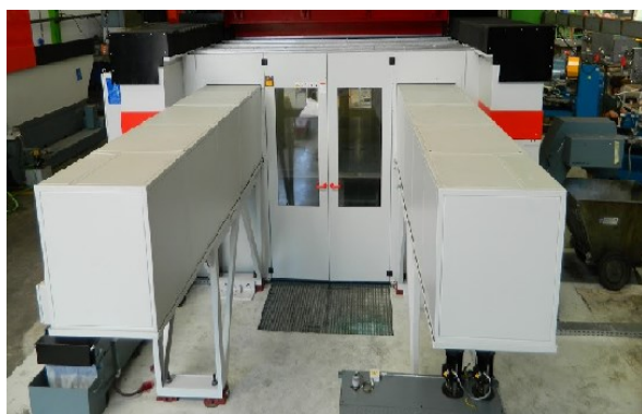
obr. 15 Použití 2 zásobníků nástrojů Trimill [10]
