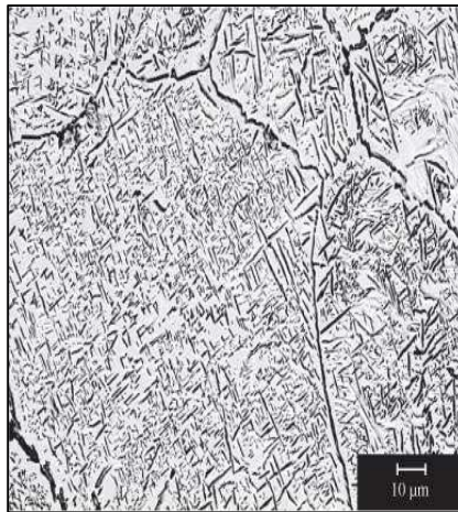
Obr. 1.6 – Mikrostruktura precipitačně vytvrzené oceli [10]
