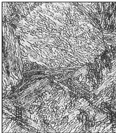
Obr. 1.2 - Mikrostruktura martenzitické korozi-vzdorné oceli [8]
