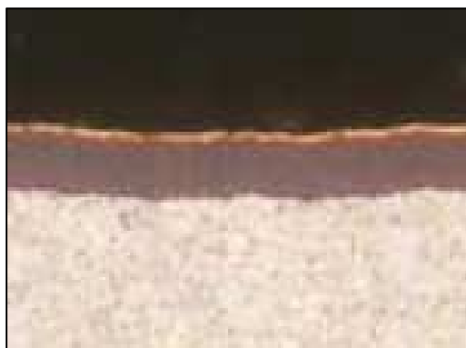
Obr. 3.4 – Struktura PVD povlaku TS2000 [20]
