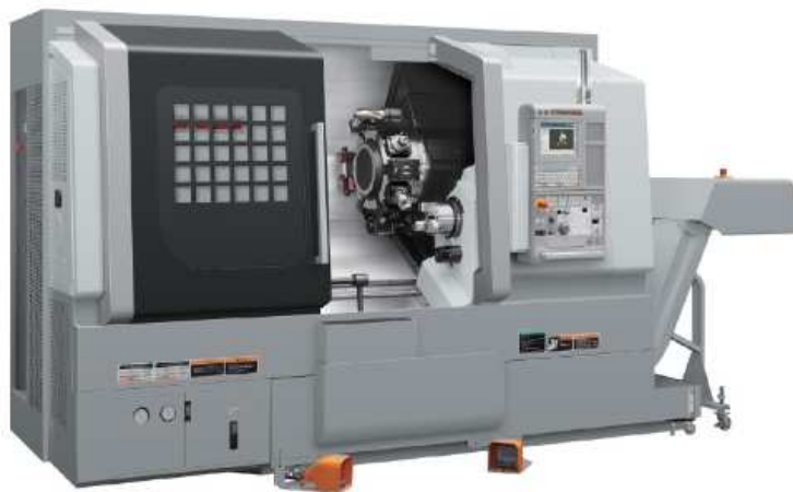
Obr. 3.2 – CNC soustružnické centrum Mori Seiki NLX2500 [19]
