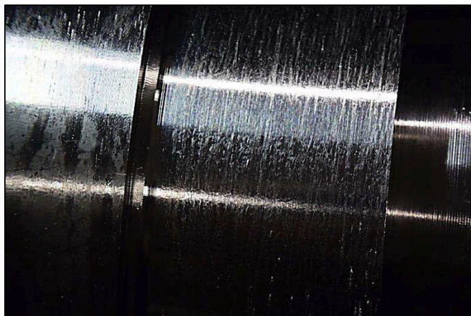
Obr. 4.3 – Drsnost obráběného materiálu při hloubce řezu 1,5 mm
