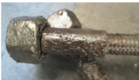
Obr. 25a: Temperovací hadice před očištěním
