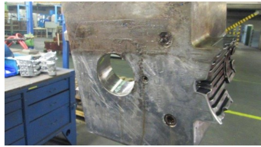
Obr. 26b: Segment po očištění
