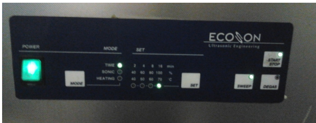
Obr. 27: Nastavení času a teploty pracovního cyklu čištění
