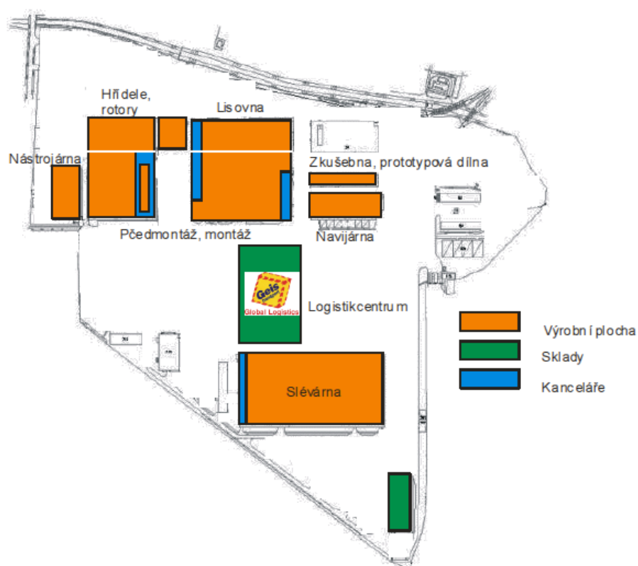
Obr 4: Situační plán výrobního podniku Siemens Mohelnice
