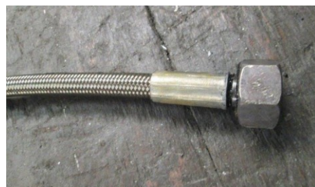
Obr. 25b: Temperovací hadice po očištění
