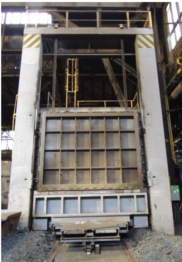
Obr. 5.15 Čelní pohled na vozokomorovou pec [Vlastní foto]
