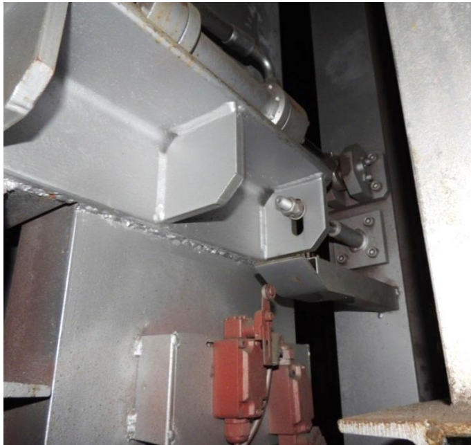
Obr. 5.18 Detail pístového hydraulického válce, k přitlačení dveří, můžeme si zde povšimnout koncového spínače [Vlastní foto]
