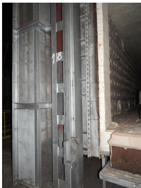
Obr. 5.5 Vlevo můžeme vidět protizávaží, vpravo pecní otvor [Vlastní foto]
