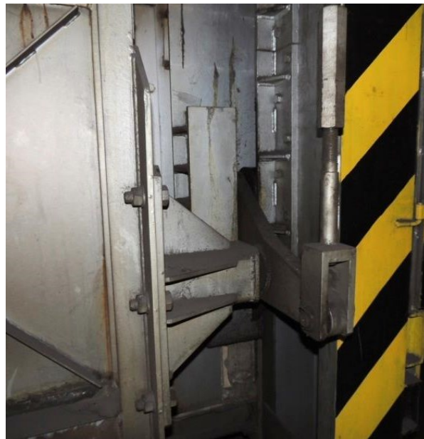
Obr. 5.11 Pákový mechanismus pro uzavření dveří [Vlastní foto]
