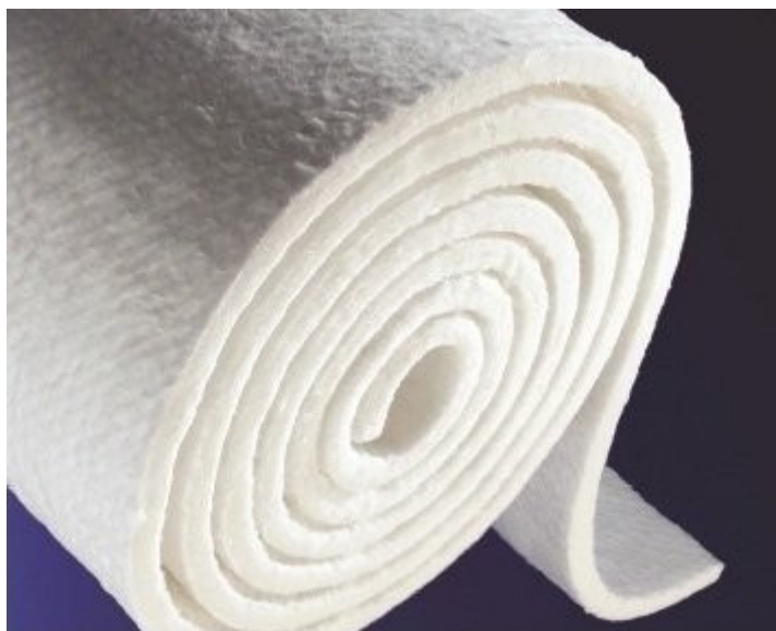
Obr. 3.6 Vlákniťá vyzdívka - Sibrál [13]
