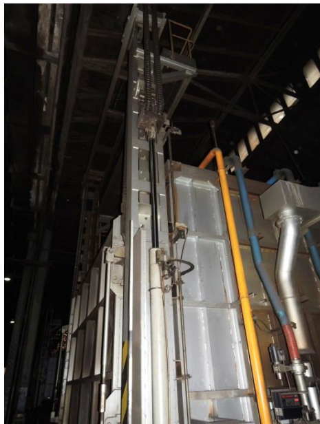
Obr. 5.10 Pohled na hydraulický válec, dveře v zavřené poloze [Vlastní foto]
