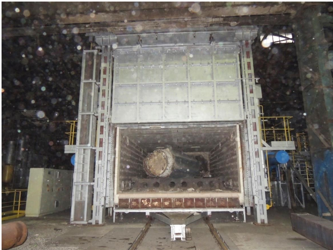
Obr. 5.3 Komorová pec vozová, celkový pohled [Vlastní foto]
