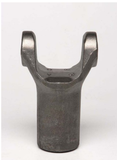
Obr. 9: Vidlice – výkovek z jakosti C45
