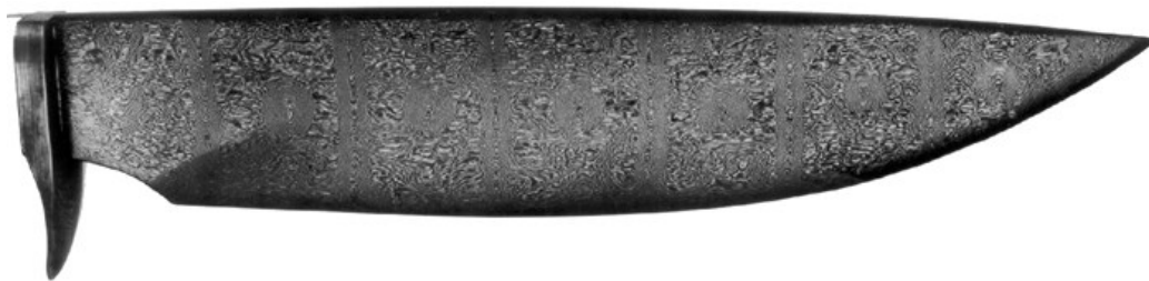
Obr. č. 4 Rekonstrukce nože s wootz čepelí. [18]
