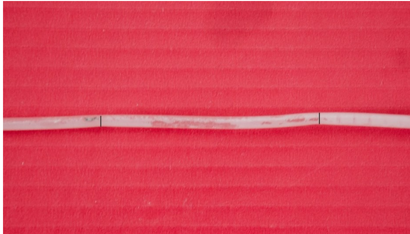
Obr. č. 7.1 Příklad deformace způsobené infuzní pumpou
