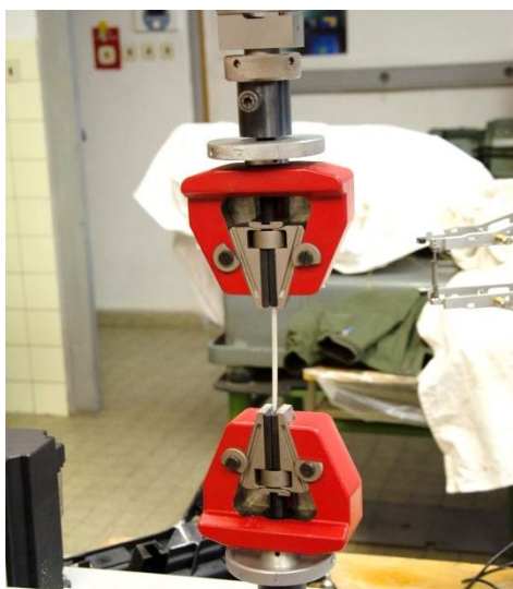
Obr. 6.3 Mechanická zkouška pevnosti tahem
