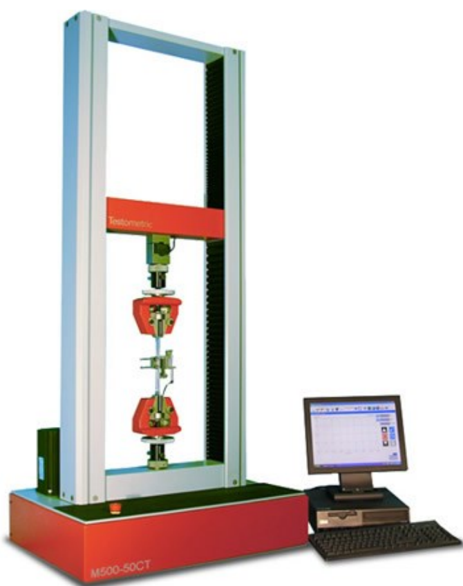
Obrázek 10: Univerzální trhací stroj Testometric M500-50CT. (23)
