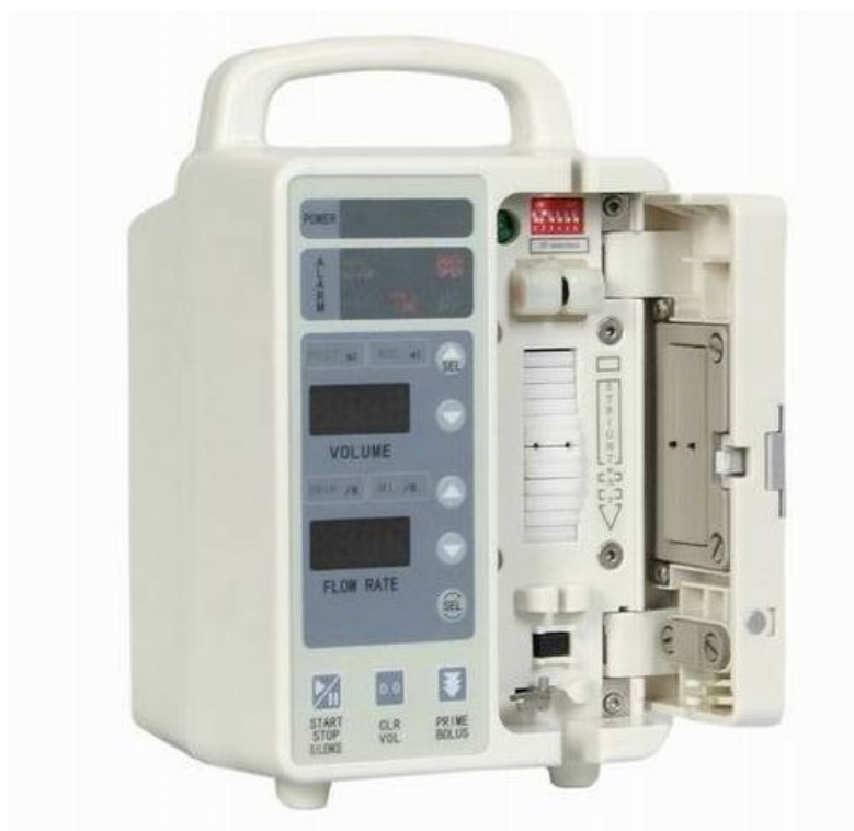
Obrázek 4: Příklad infuzní pumpy s lamelovým čerpadlem. (20)
