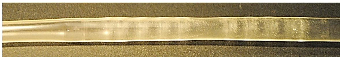
Obrázek 17: Makrosnímek segmentu použitého infuzního setu, namáhaného činností lamel infuzní pumpy.
