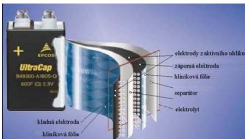
Obr. 5: Struktura superkondenzátoru. [6]
