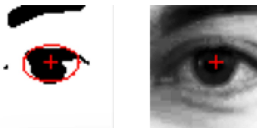
Obrázek 15 - Vlevo binární obrázek s nalezenou elipsou a jejím středem. Vpravo obrázek oka a jeho střed.
