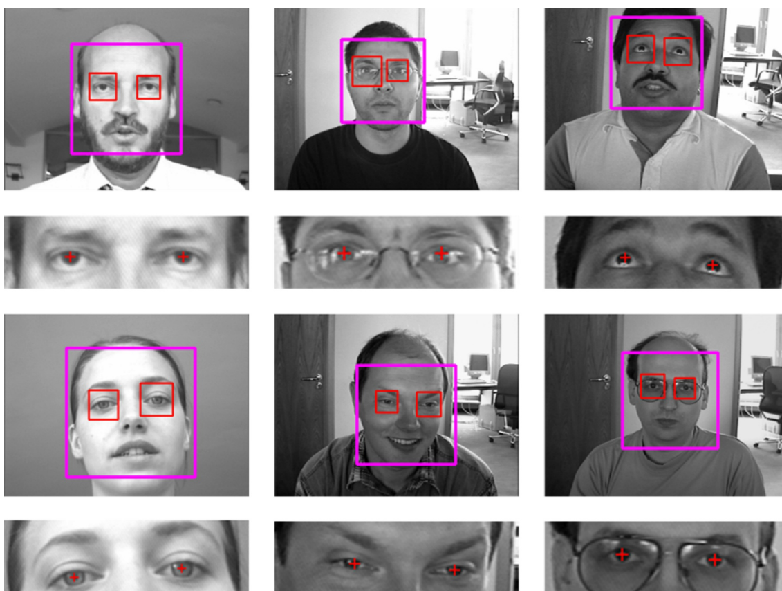
Obrázek 35: Výběr úspěšných detekcí středů očí pomocí metody lokalizace středu oka pomocí gradientů.
