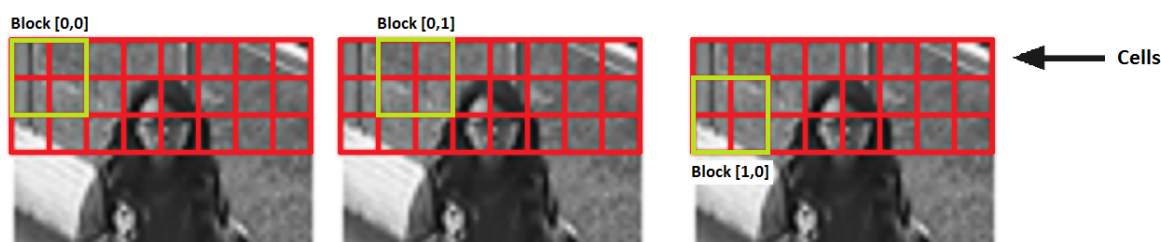
Obrázek 12: Ukázka seskupování jednotlivých buněk (cells) do větších bloků (blocks). Pro bloky je zde použito překrývání 50%. Velikost buňky je zde určena jako 8 \times 8 pixelů a velikost každého bloku pak 2 \times 2 buňky.
