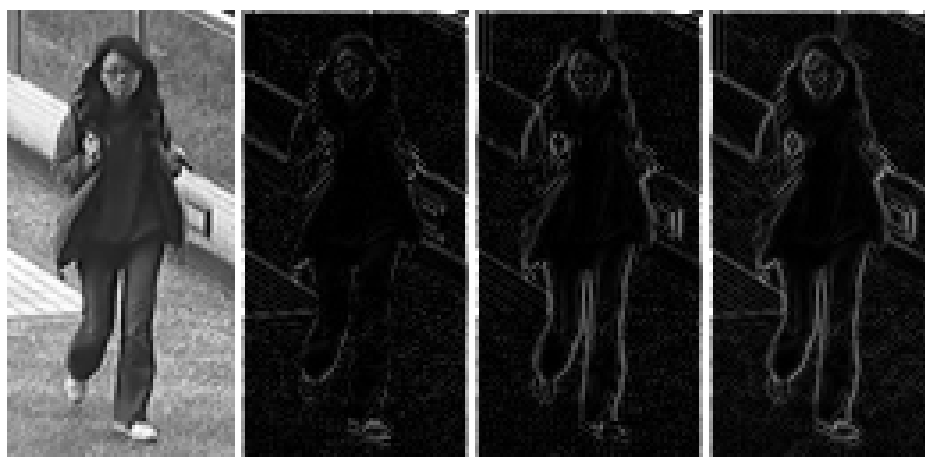
Obrázek 11: a)Původní snímek ve stupních šedi. b)Absolutní hodnoty derivací ve vertikálním směru. c)Absolutní hodnoty derivací v horizontálním směru. d)Výsledná velikost gradientu.
