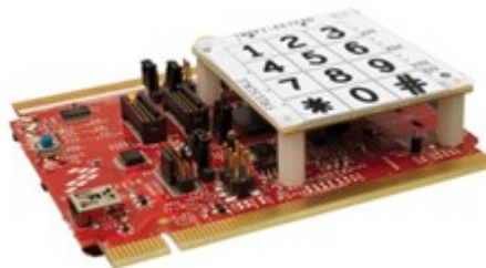
Obrázek 2 Vývojový kit s kapacitními tlačítky ve tvaru klávesnice (2)
