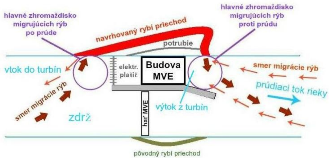
Obrázok 15 - Navrhované opatrenia pre zlepšenie reprodukčnej migrácie rýb v oboch smeroch (Zdroj:prevzaté a upravené z DRUGA, 2014)
