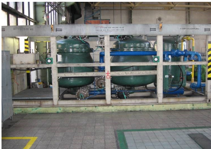
Obrázek č. 5: Jednotka uhlikových molekulových sít, PSA, CMS 600 (foto Adamus).
