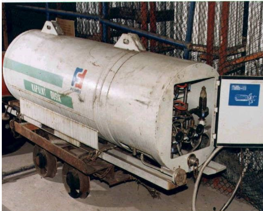
Obrázek č. 11: Kontejner pro operativní přepravu kapalného dusíku (foto Adamus).
