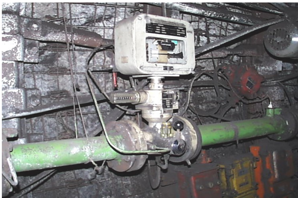
Obrázek č. 13: Turbínový průtokoměr TZ 80/250 Rombach (foto Adamus).
