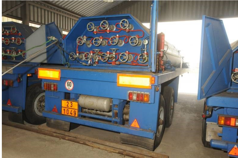
Obrázek č. 9: Vlek s tlak. láhvemi o kapacitě 630 m 3 (foto Zielinski).
