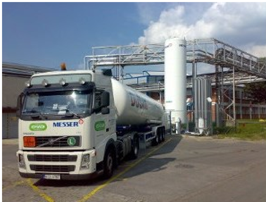
Obrázek č. 10: Cisterna pro přepravu kapalného dusíku (foto Tomala).
