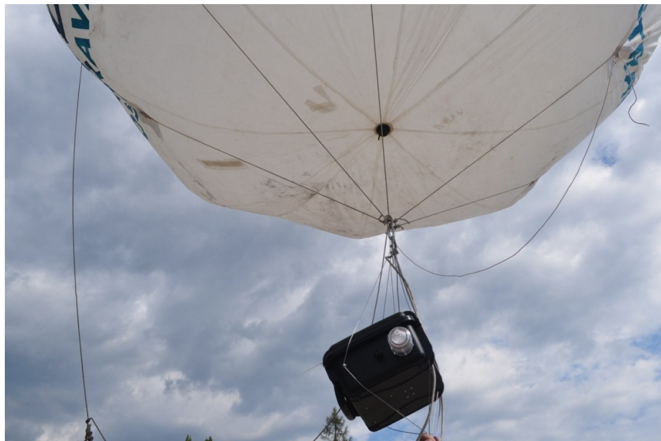
Obrázok 5: Upevnenie odberového čerpadla k balónu (Štrbová, 2014)
