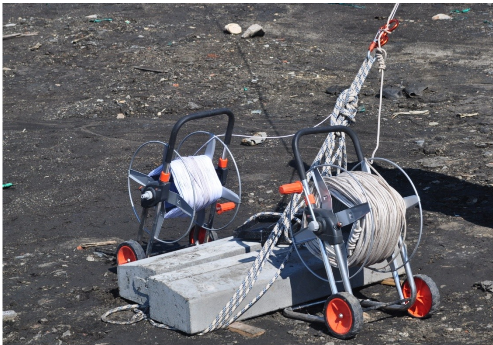
Obrázok 7: Pripútanie balóna pomocou padákovej šnúry k navijaku (Štrbová, 2014)
