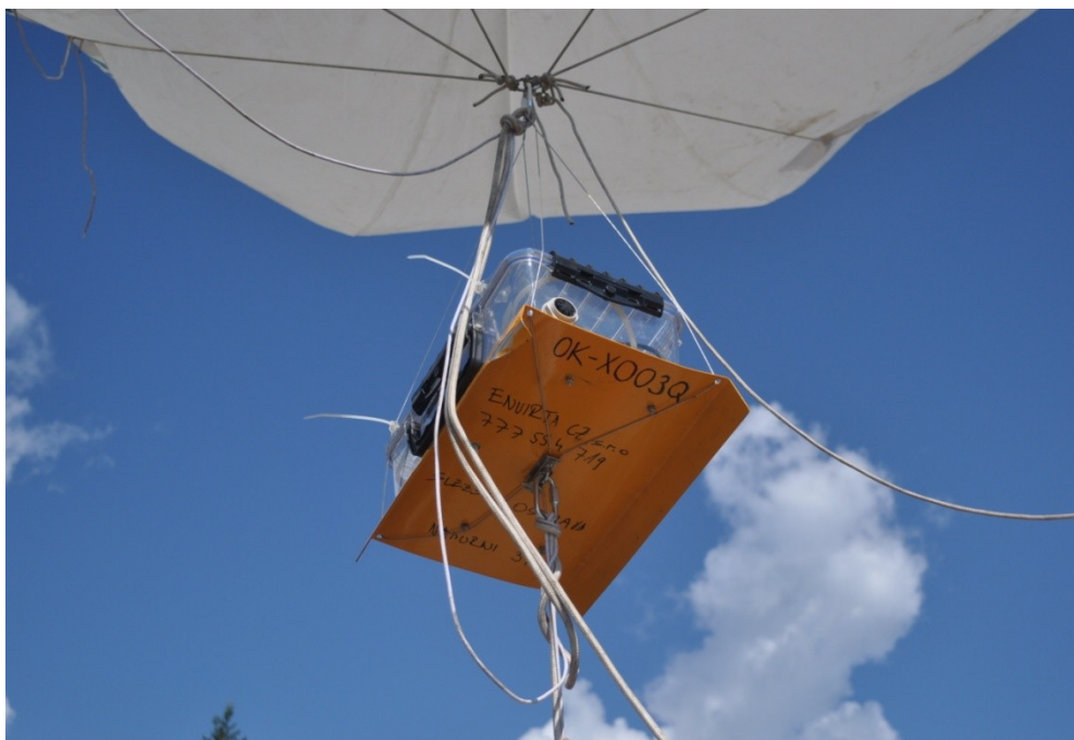
Obrázok 3: Upevnenie prachomeru Grimm 1.108 k balónu (Štrbová, 2014)
