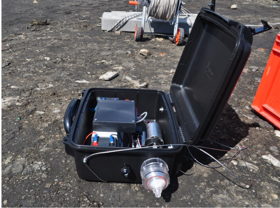
Obrázok 4: Odberové čerpadlo (Štrbová, 2014)
