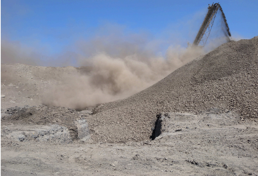
Obr. 12: Tvarování koruny výsypky r. 2014 (Severočeské doly a.s.)
