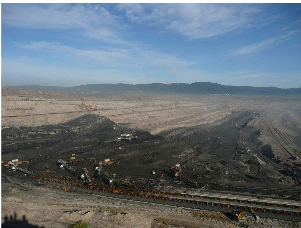
Obr. 2: Skrývkové řezy a uhelná sloj (Severočeské doly a.s.), datum 2014
