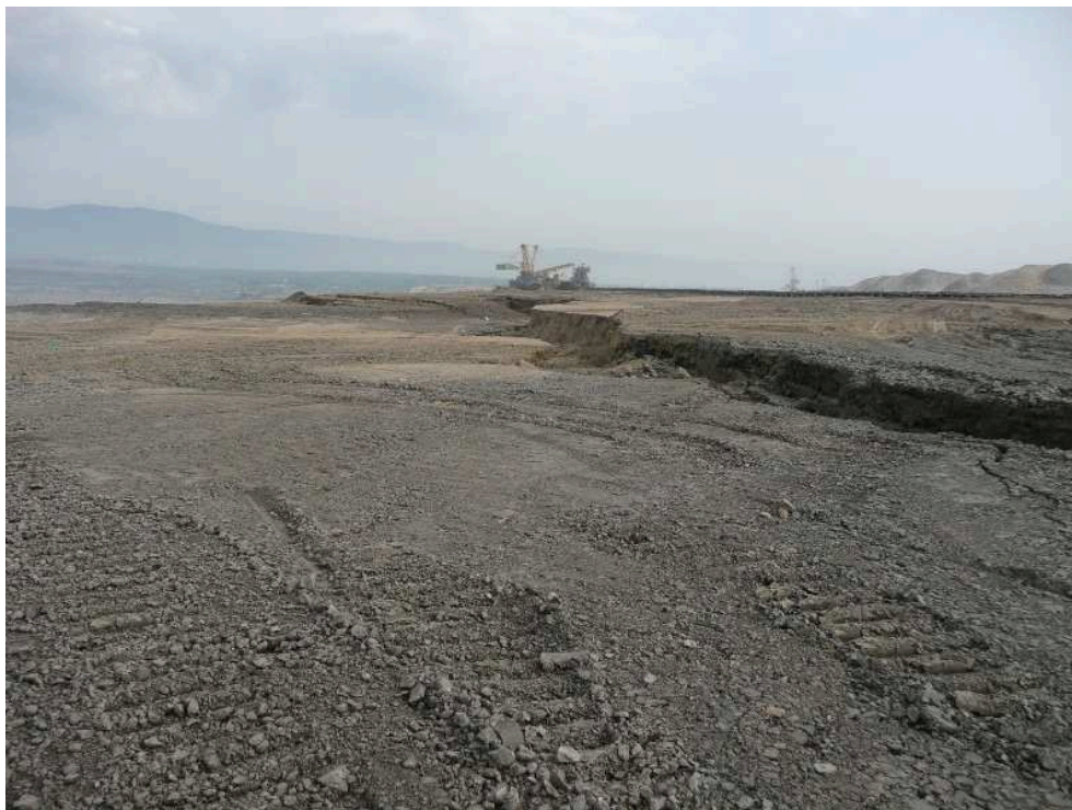
Obr. 6: Pohled na nestabilitu výsypkové etáže – vnitřní výsypka Bílina r. 2014 (Severočeské doly a.s.)
