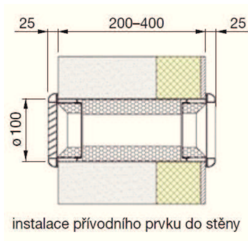
Obr. 36: Ukázka instalace přívodního prvku na stěně tl. 100 mm (zdroj: www.elektrodesign.cz )
