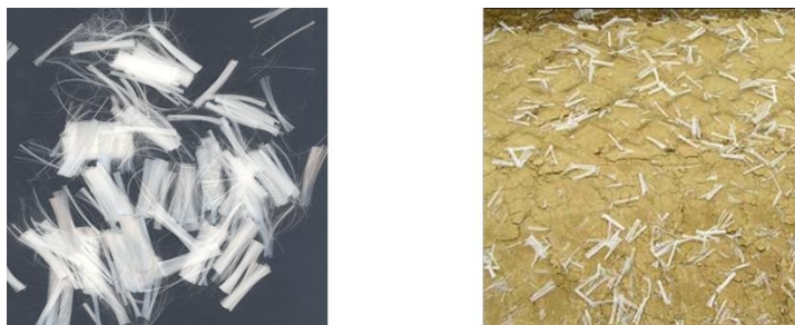
Obr. 3 - Vlákna a vyztužení zeminy krátkými vlákny.
