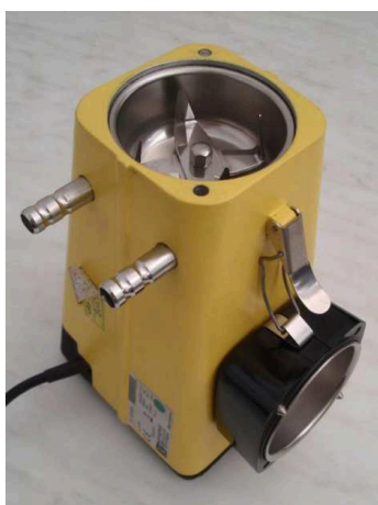
Obrázek 11. Nožový mlýnek pro mletí laboratorně připravených frikčních kompozitů [81]
