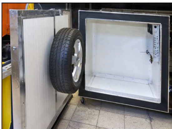
Obrázek 16. Pohled do prostoru chladicího boxu, který uzavírá brzdovou soustavu v průběhu mechanického testování
