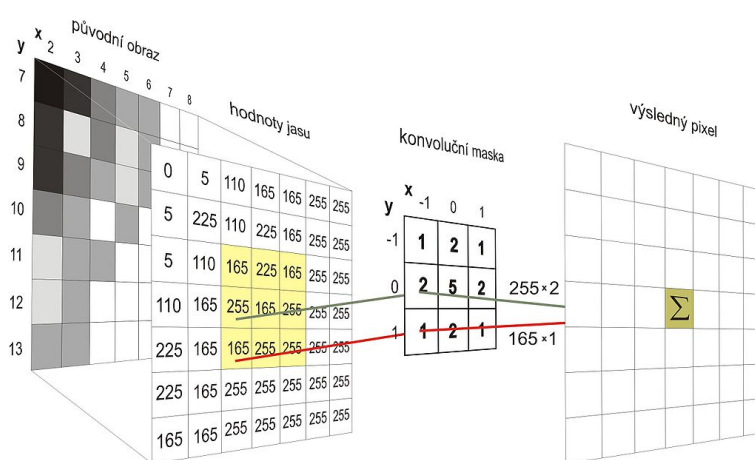
Obrázek 3: Proces konvoluce. Zdroj: http://cs.wikipedia.org/wiki/Konvoluce
