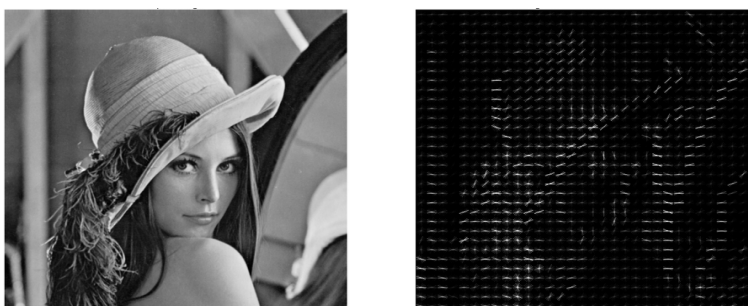
Obrázek 4: Znáznornění orientovaných gradientů. Zdroj: http://pavel.campr.cz/public/scikits-image-hog-fix/hog_lena_old.png
