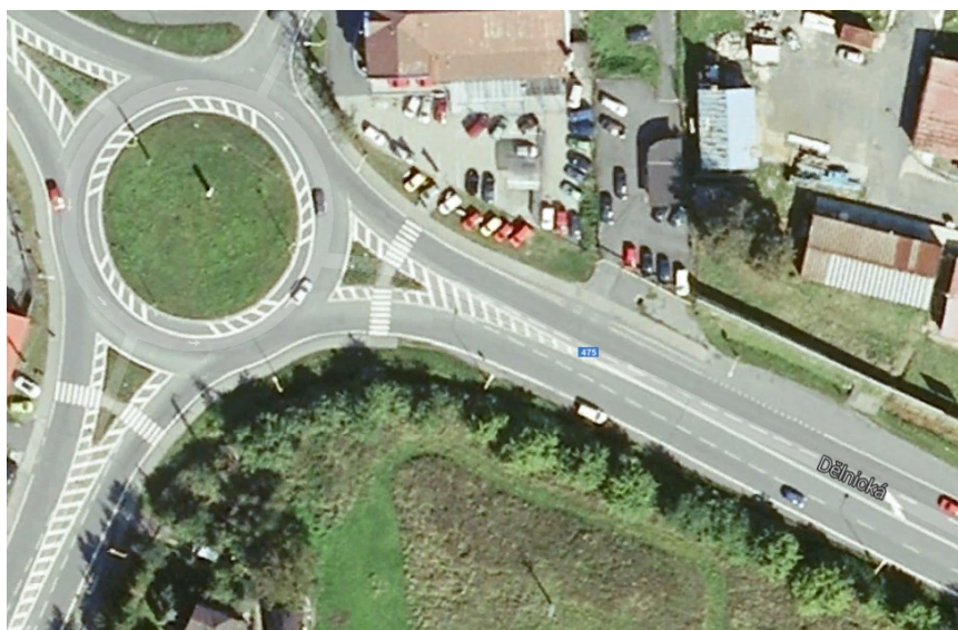
Obr. č. 16 - Riešenie redukcie jazdných pruhov na susednej okružnej križovatke [2]
