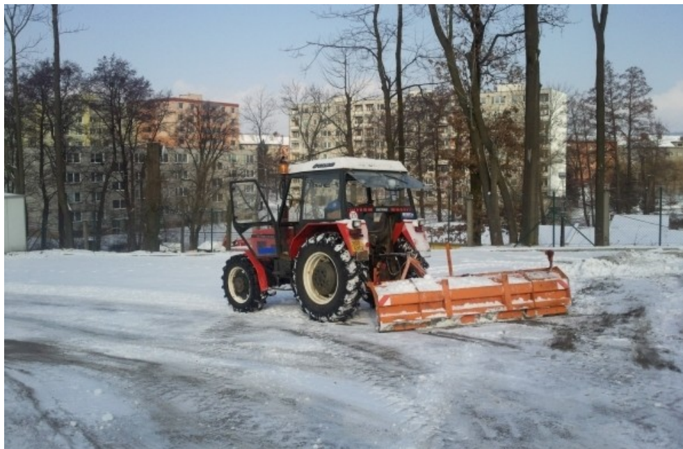
Obrázek č. 1 Plužení komunikací traktorem se zadní radlicí 23
