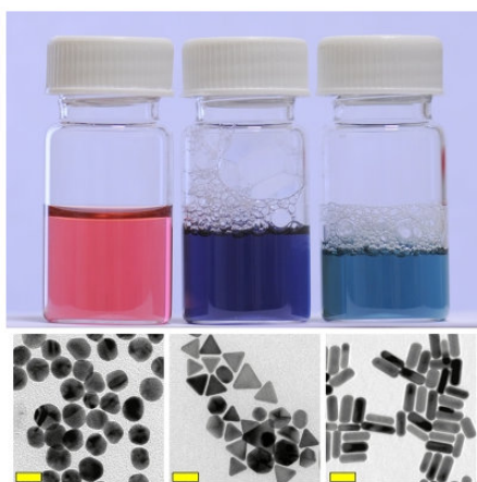
Obr. 4 Koloidní roztoky zlata a snímky z transmisního elektronového mikroskopu (měřítko 30 nm), kde můžeme pozorovat změnu optických vlastností v závislosti na tvaru nanočástic. Roztoky obsahují 0,05 mg zlata/ml ( \sim 10^{11} částic/ml) [42]
