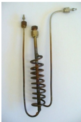
Obr. 11: Trubkový reaktor se spirálovitým vinutím k předehřívání plynu
