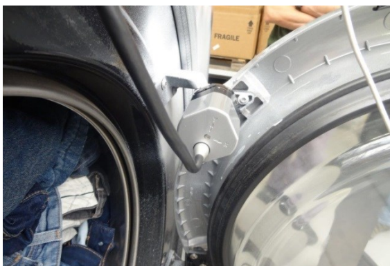
Obr. 9.12 Umístění snímače na pantu
