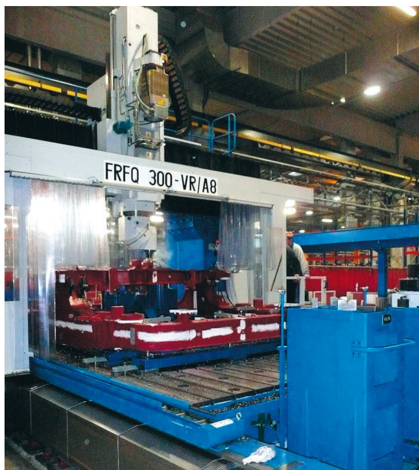
Obr. 2.2 Portálové obráběcí centrum FRFQ300-VR/A8 při obrábění tramvajového podvozku
