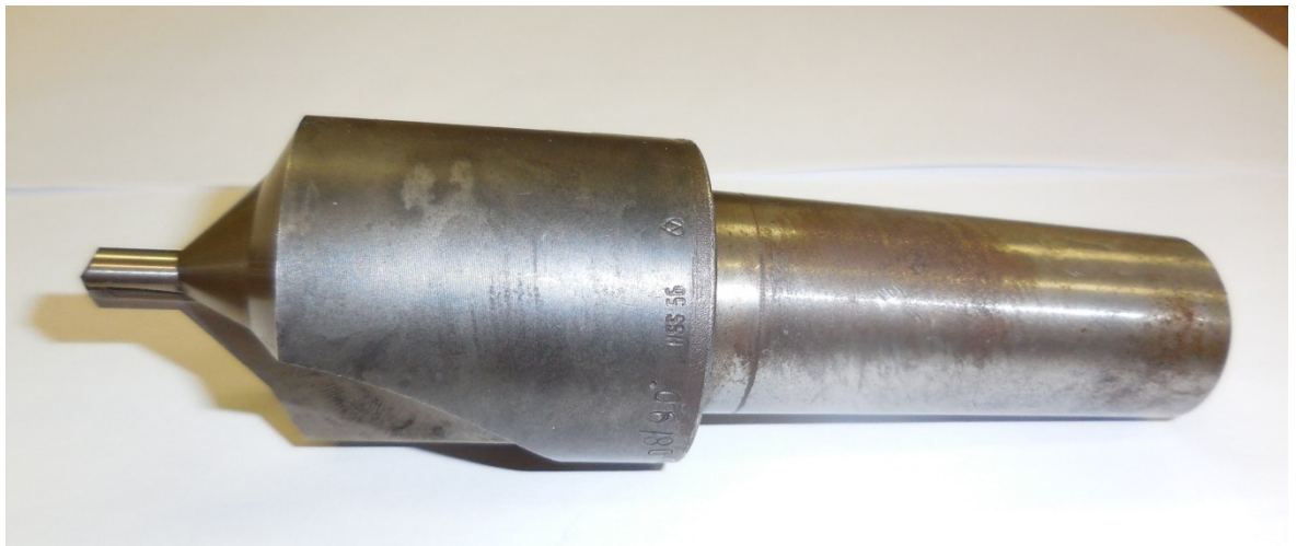
Obr. 3.9 Odstupňovaný šroubovitý vrták \varnothing 5 \text{ mm} / 90^\circ / 120^\circ
