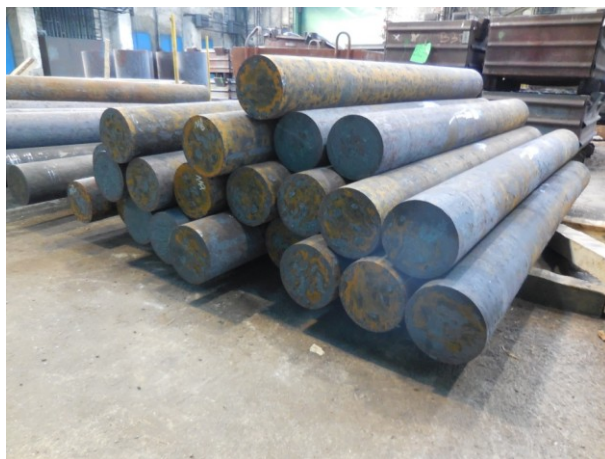
Obr. 3.4 Tyče po tepelném zpracování a zkoušce tvrdosti
