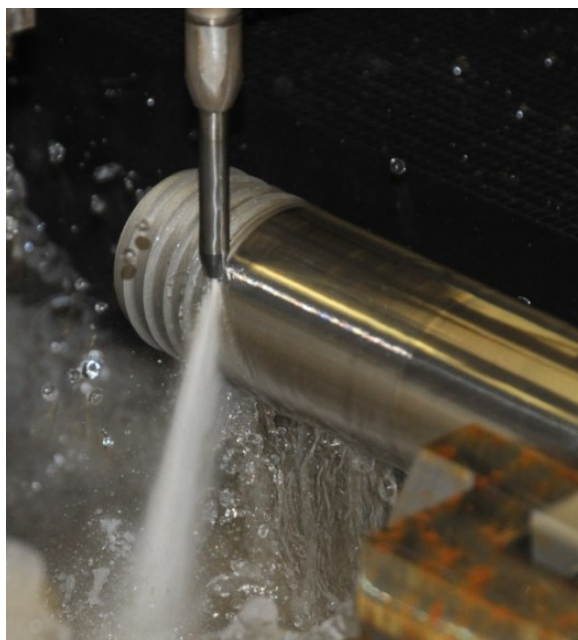
Obr. 18 Hydroabrazivní soustružení slitiny Incoloy 925 [Zlámal, T. et al.]
