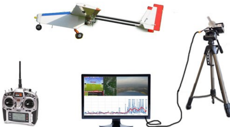
Obrázek 4.2: Hlavní části bezpilotního systému Stalker (vlastní foto)
