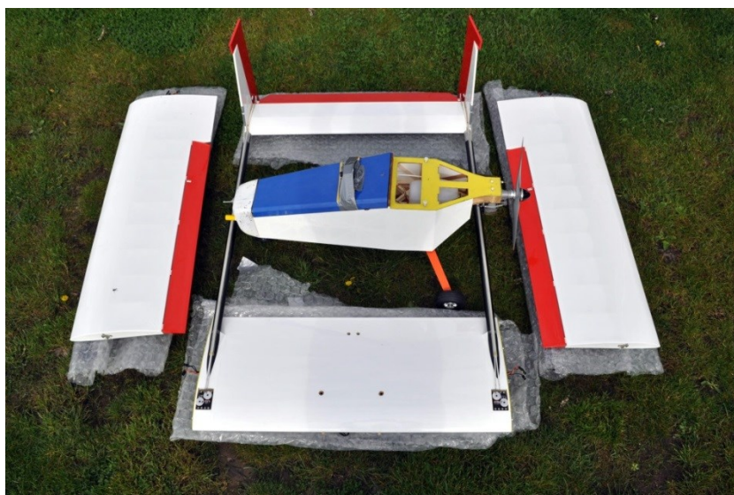
Obrázek 4.4: Hlavní části bezpilotního letadla Stalker (vlastní foto)
