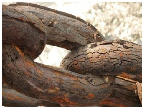
Obrázek č. 1 Chemická koroze [3]
