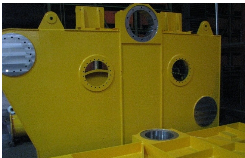
Obrázek č. 19 Vrchní nátěr konstrukce
