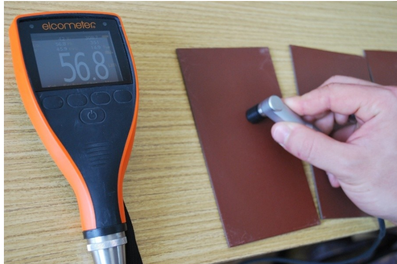
Obrázek č. 22 Měření suché tloušťky na základním nátěru
