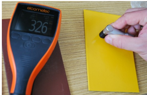
Obrázek č. 23 Měření suché tloušťky na vrchním nátěru
