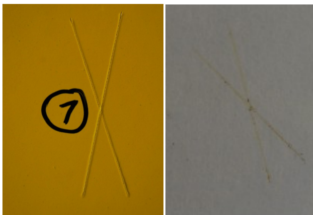
Obrázek č. 26 Měření křížového řezu na vrchním nátěru
