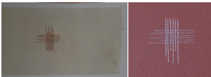
Obrázek č. 24 Měření mřížkového řezu na základním nátěru
