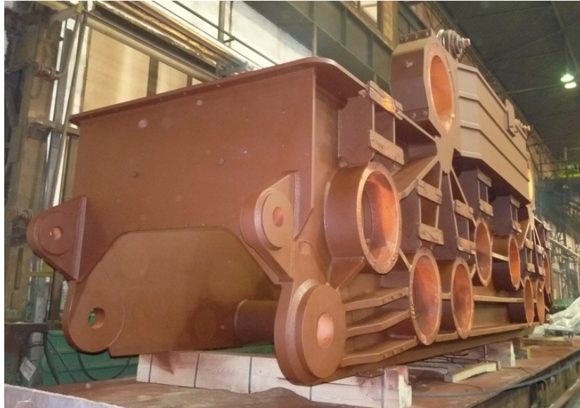
Obrázek č. 15 Základní nátěr konstrukce
