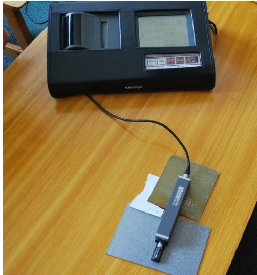
obrázek č. 21 Měření drsnosti pomocí přístroje MITUTOYO SJ-301
