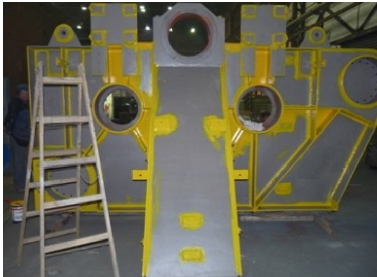
Obrázek č. 18 Pásový nátěr na konstrukci
