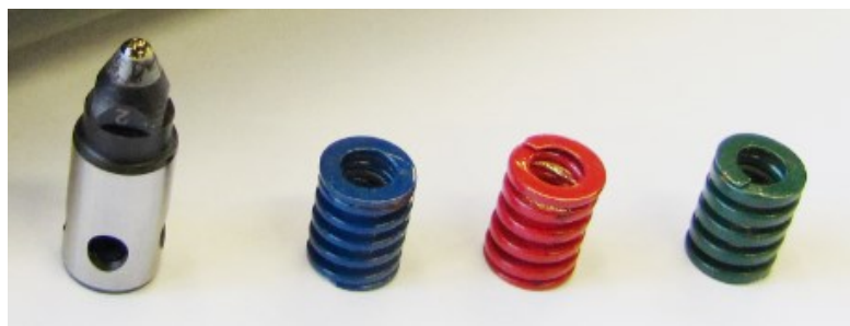
Obr. 8 Diamantový hrot a pružiny různé tvrdosti
