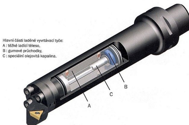
Obr. 3 Laděná vyvrtávací tyč pro vnitřní soustružení [5]
