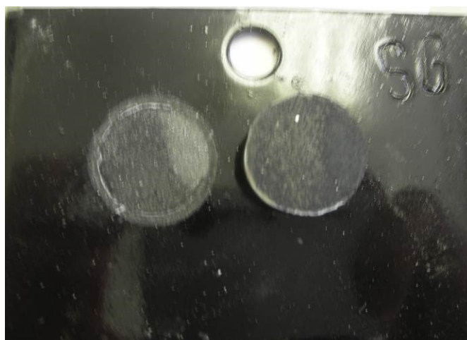
Obrázek č. 19 – Vyhodnocení odtrhové zkoušky 1. panenky u vzorku „MA“
